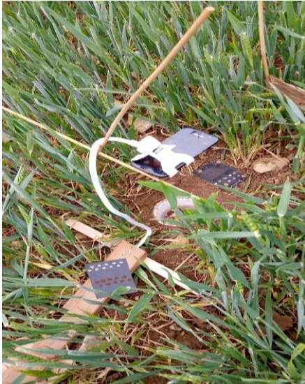
Figure 2 : Support du smartphone en « col de Cygne » avec deux pinces, et installation en milieu naturel pour visionner les cartes de prédation (Photo : Komla Xola Dohokou, supervisée par Helmut Meiss)
